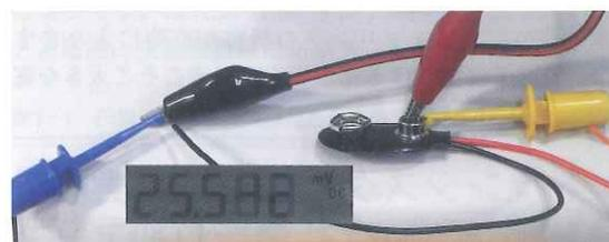
写真5-7 電池スナップ単体で抵抗を測定
