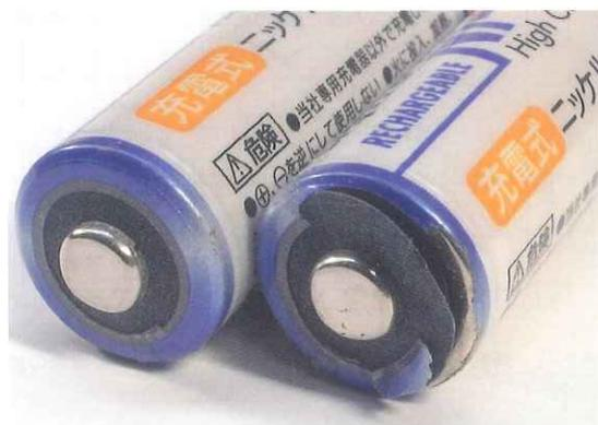
写真1-8 長期間充電電池を使うと衝撃で外装ラベルが破損することがある
