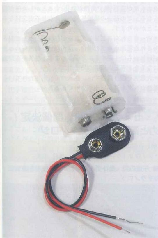
写真5-5 電池スナップと電池スナップ対応の電池ホルダ
