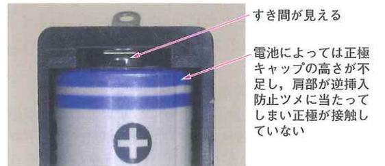
写真3-6 正極キャップの高さが不足しているニッケル水素電池を挿入したところ
