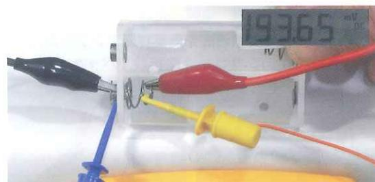
写真5-8 コイルばね電極から電池スナップ接続キャップまでの抵抗を測定
