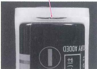
写真3-3 マンガン電池を逆挿入したところ
