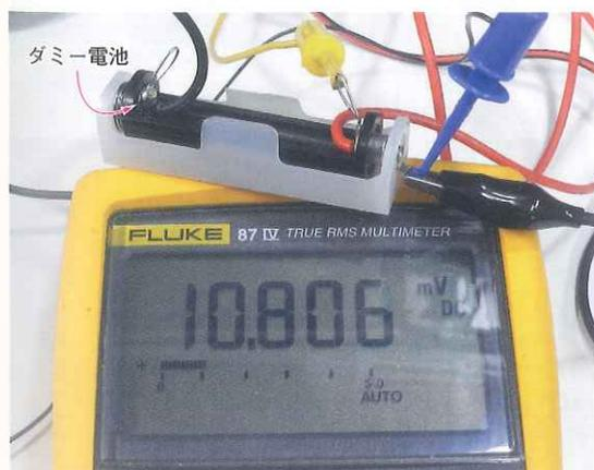
写真4-3 はんだ付け前の接触状態を測定。接触抵抗は10mΩ
